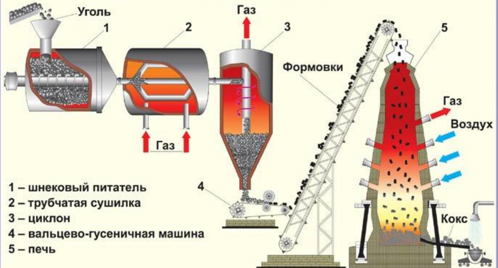
СХЕМА НЕПРЕРЫВНОГО КОКСОВАНИЯ УГЛЯ
