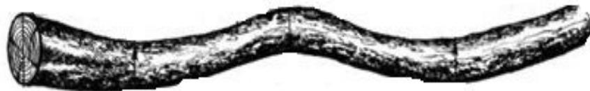
**Покоробленность** — искривление пилопродукции при выпиловке, сушке или хранении. Покоробленность бывает простая продольная по пласти, сложная продольная по пласти, продольная по кромке, поперечная и крыловатость.
