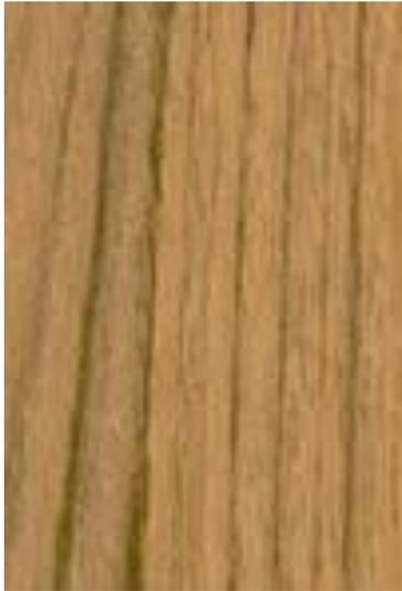
Тик хорошо поддается всем видам механической обработки, очень устойчив к нагрузкам и внешним воздействиям.
