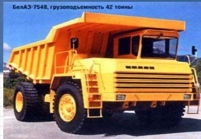
БелАЗ-7548, грузоподъемность 42 тонны
