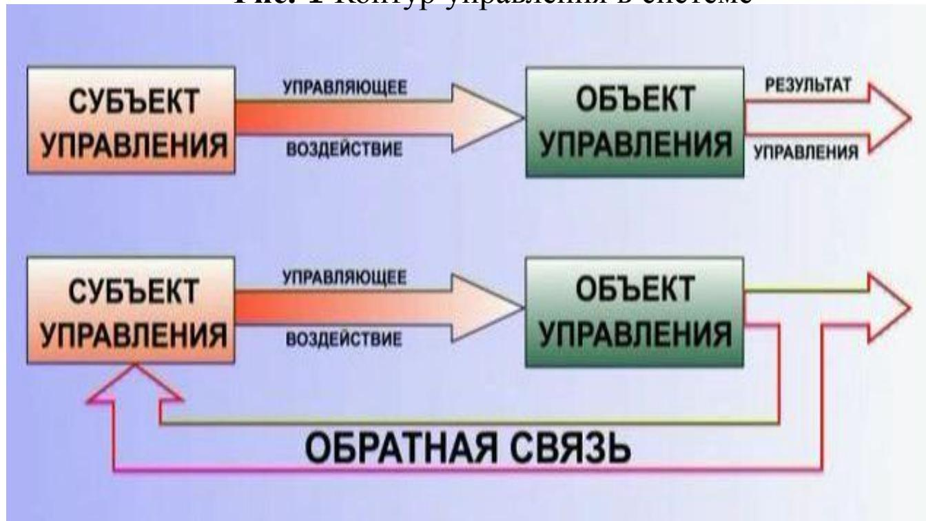
**Рис. 2** Контур управления системы, находящейся во внешней среде
