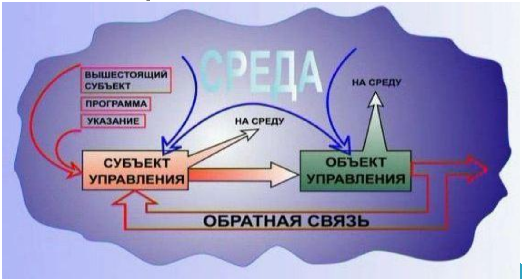
Рис. 2 Контур управления системы, находящейся во внешней среде
