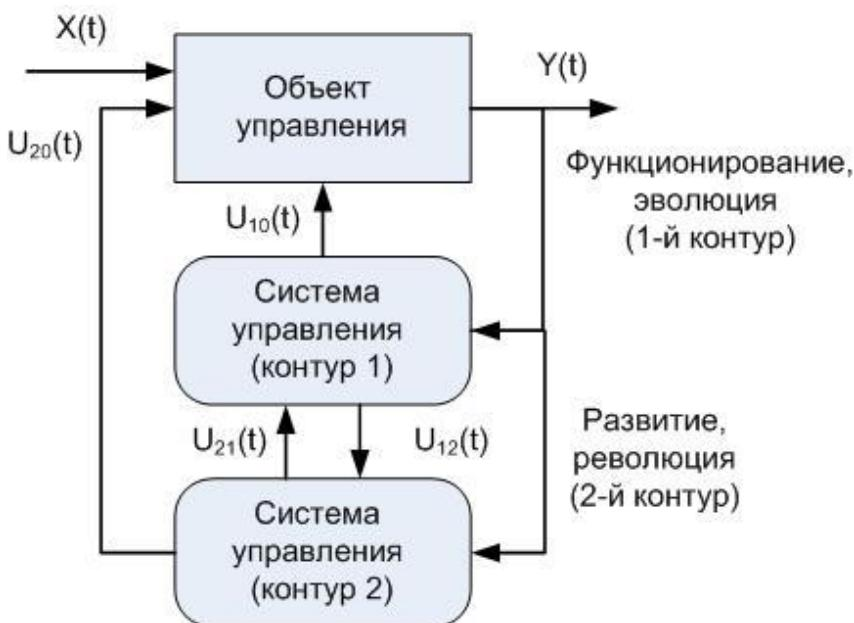
Первый контур системы управления  $\{Y(t) \rightarrow U_{10}(t)\}$  обеспечивает стабилизацию выходов  $Y(t)$  объекта (гомеостазис) и отвечает за его эволюционное развитие.
