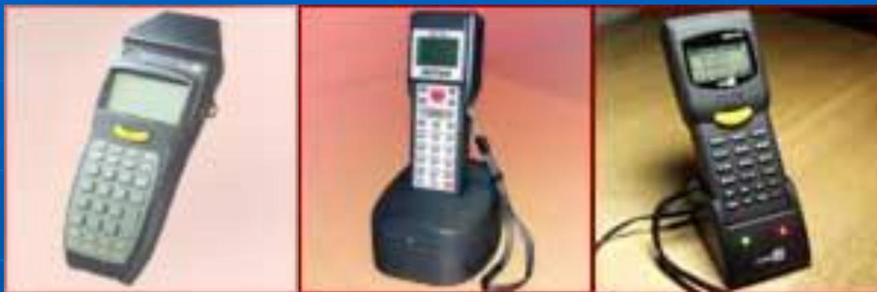
**Снабженные сканером штрихового кода, мобильные терминалы сбора данных. Он может облегчить и ускорить работу официанта в ресторане (прием заказов), продавца в зале торговли по образцам при оформлении покупки, кладовщика в процессе отпуска или приходования товаров.**
