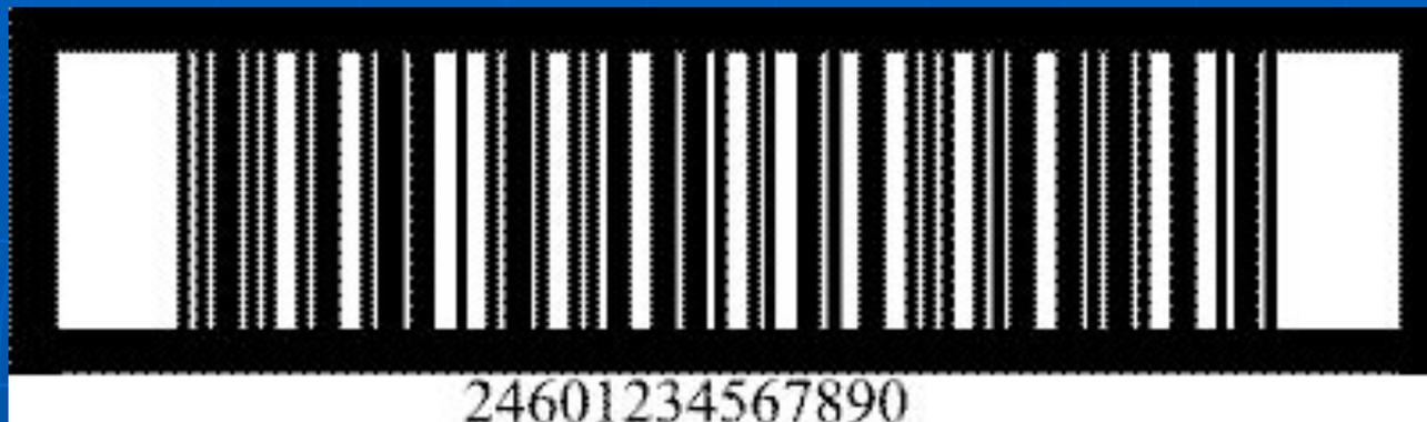
На транспортную упаковку в виде штрихового кода наносится 14-разрядный номер EAN-14. При этом используется графическая символика "2 из 5 чередующийся" (англ. Interleaved Two of Five – ITF). Поэтому и штриховой код сокращенно называют ITF-14
