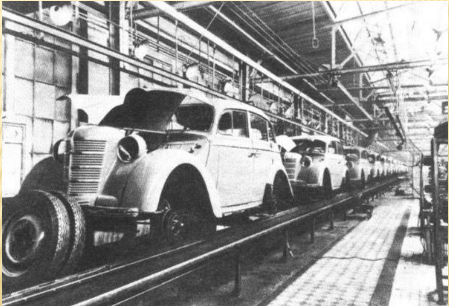
Конвейерная сборка автомобилей
