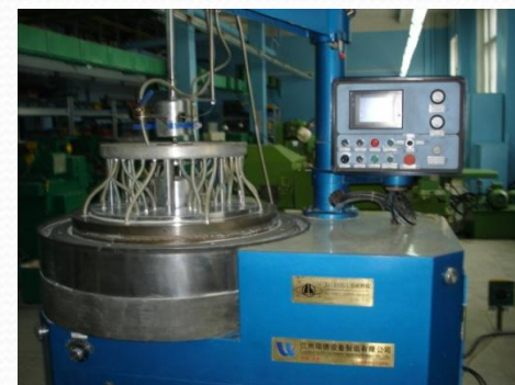
Двусторонняя шлифовка X61-850B1 (Китай)
