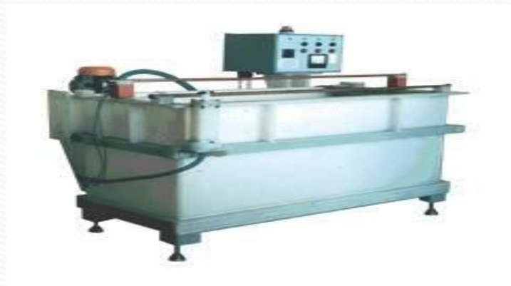
Никелирование гальваническая линия (Китай)
