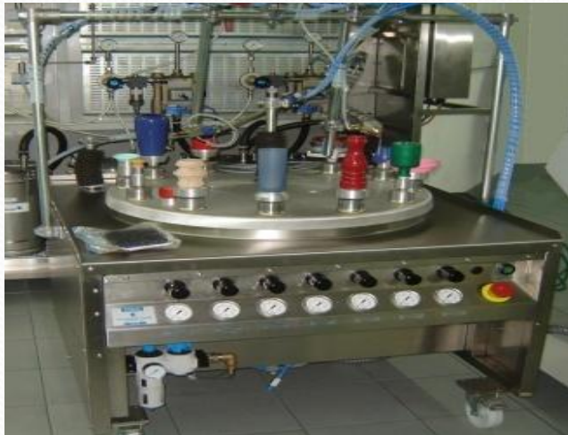
Нанесение глазури установка MP-400 (Германия)
