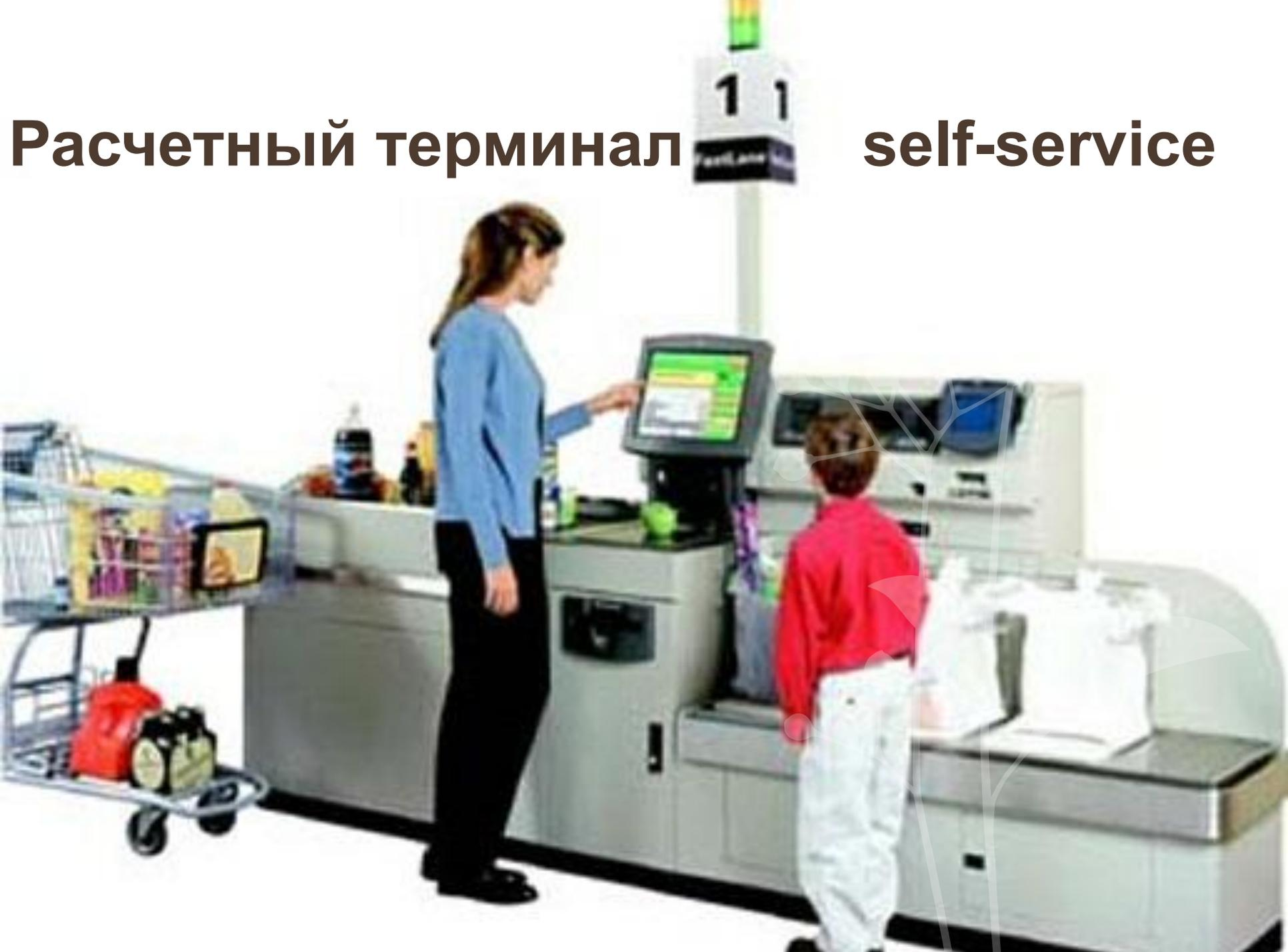
**Расчетный терминал self-service позволяет покупателю самостоятельно сканировать товары и оплачивать счет как наличными, так и банковскими картами. Розничное предприятие получает при этом весомую экономию на заработной плате кассиров, которые в Штатах получают до \$10 в час. Обычно четыре кассы self-service обслуживает один контролер, который на мониторе отслеживает все, что сканируют и оплачивают клиенты.**
