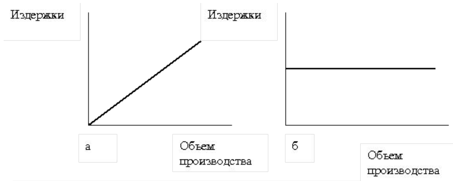
Зависимость переменных издержек (а) и условно-постоянных издержек (б) от изменения объемов производства
