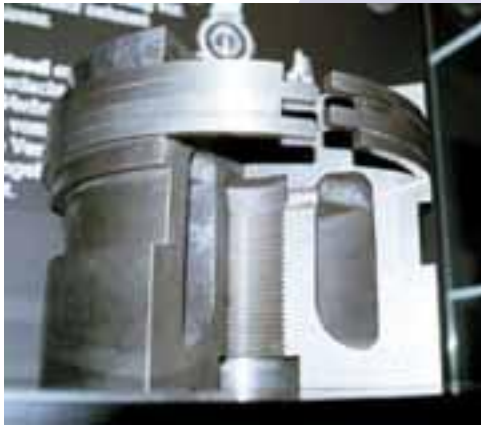
Антифрикционный чугунный поршень
