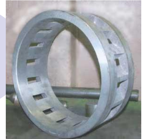
Износостойкий чугун (роторный измельчитель)
