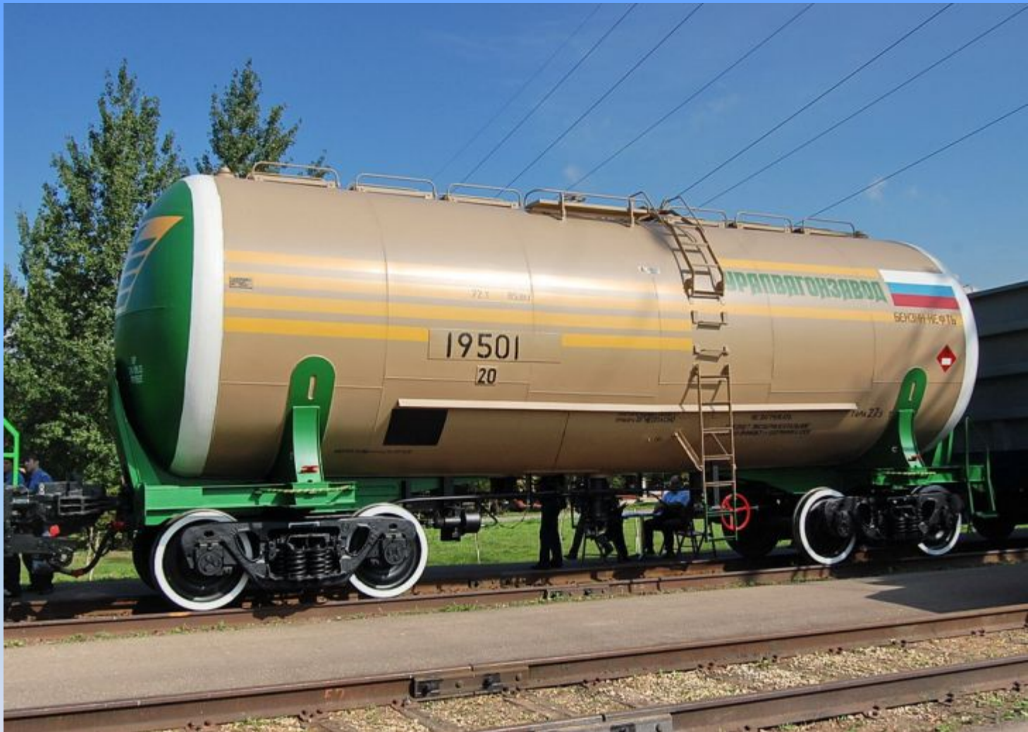
Цистерна для перевезення бензину-нафти
