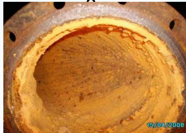
Соединительный патрубок Правая часть до установки УНН
