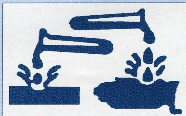
Символ с изображением пробирок с едкой жидкостью и обозначением C означает "едкое"
