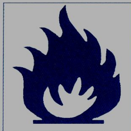
Символ в виде пламени с обозначением F+ означает "чрезвычайно воспламеняющийся", с обозначением F - "легко воспламеняется"
