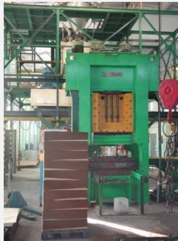
Изготовление резинопровбковых блоков
