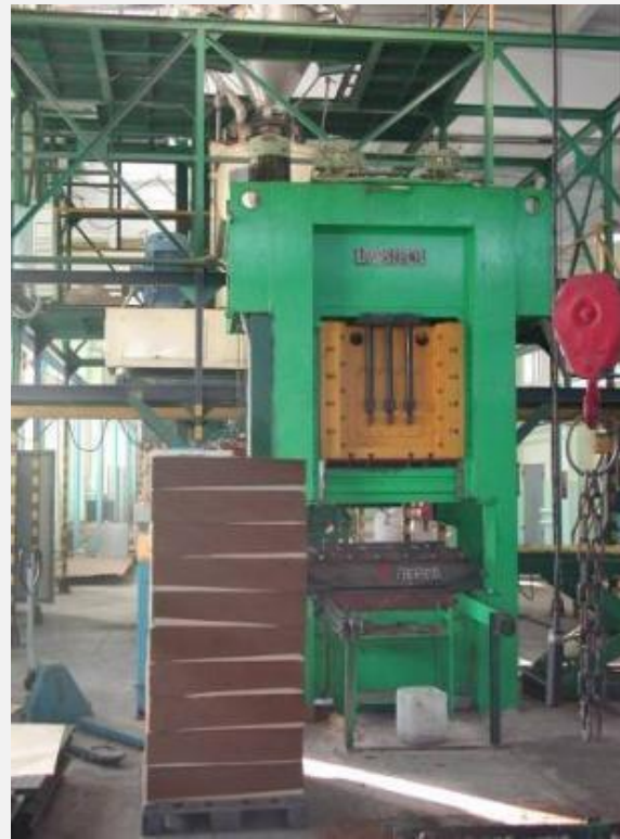
Изготовление резинопровбковых блоков
