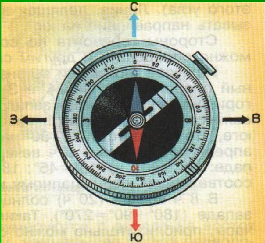
Для определения сторон горизонта необходимо положить компас горизонтально и повернуть его так, чтобы северный конец стрелки компаса совпадал с нулевым делением шкалы. При таком положении стрелка компаса показывает направление север – юг.
