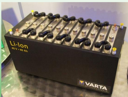
Модуль оливиновой батареи электромашины.
