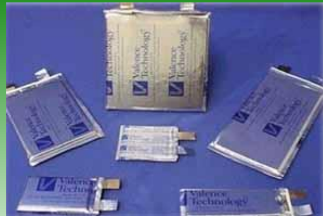
ОЛИА в мягком корпусе фирмы Valence.
