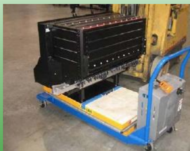
Батарея для электромобиля
