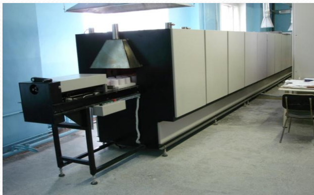
Оплавление глазури печь электрическая GMQ 4030-15 NM (Китай)
