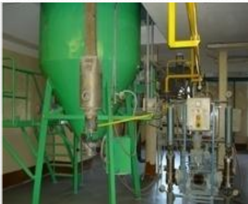
Получение гранулята Гранулятор фирмы Niro A/S
