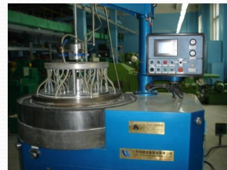
Двусторонняя шлифовка X61-850B1 (Китай)
