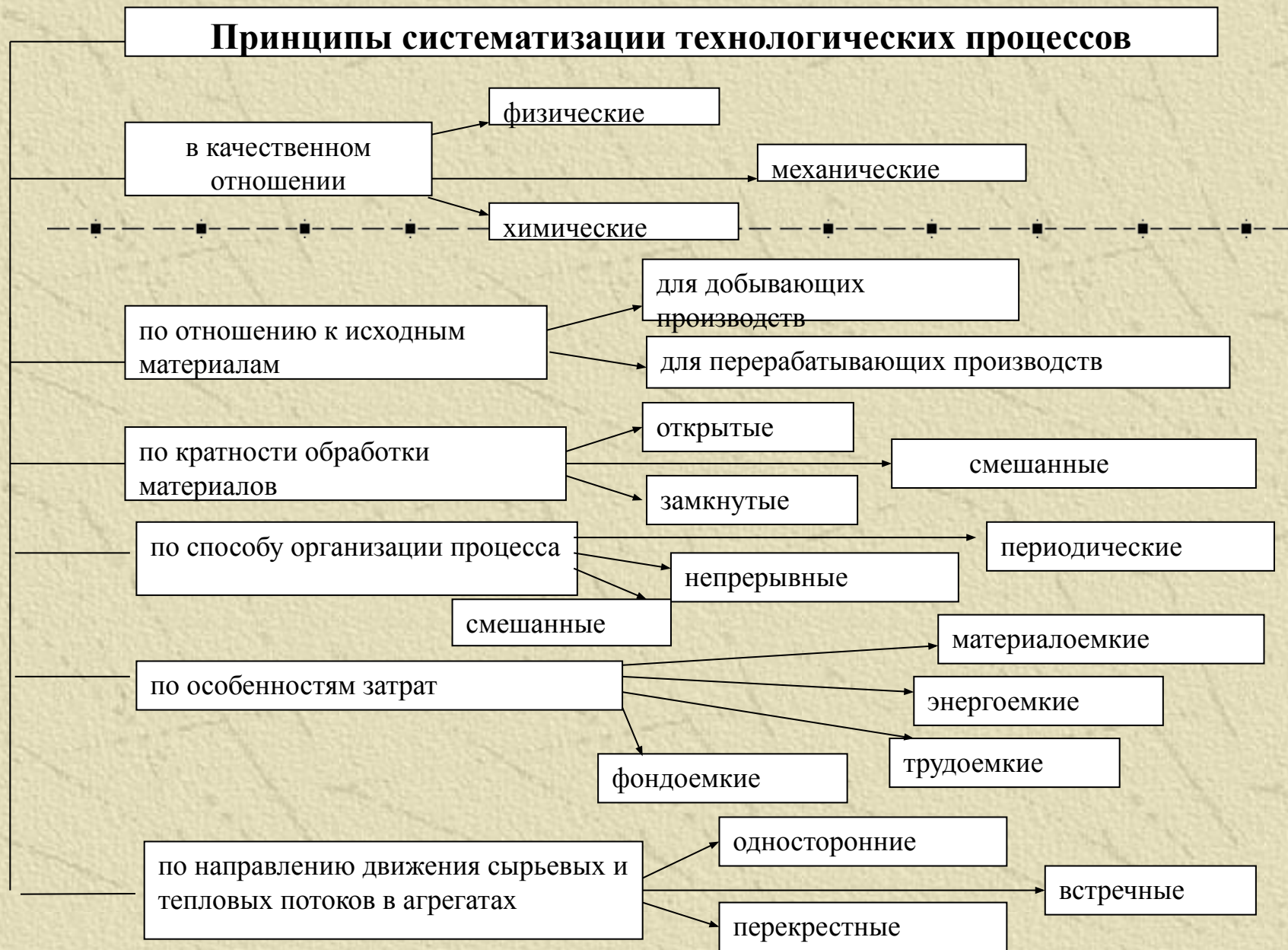
Рис. 2. Классификация технологических процессов
