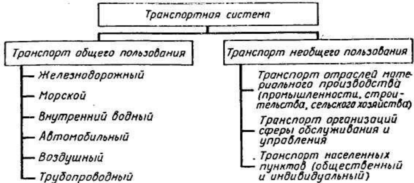
Рис. 1.2. Структурная схема транспортной системы
