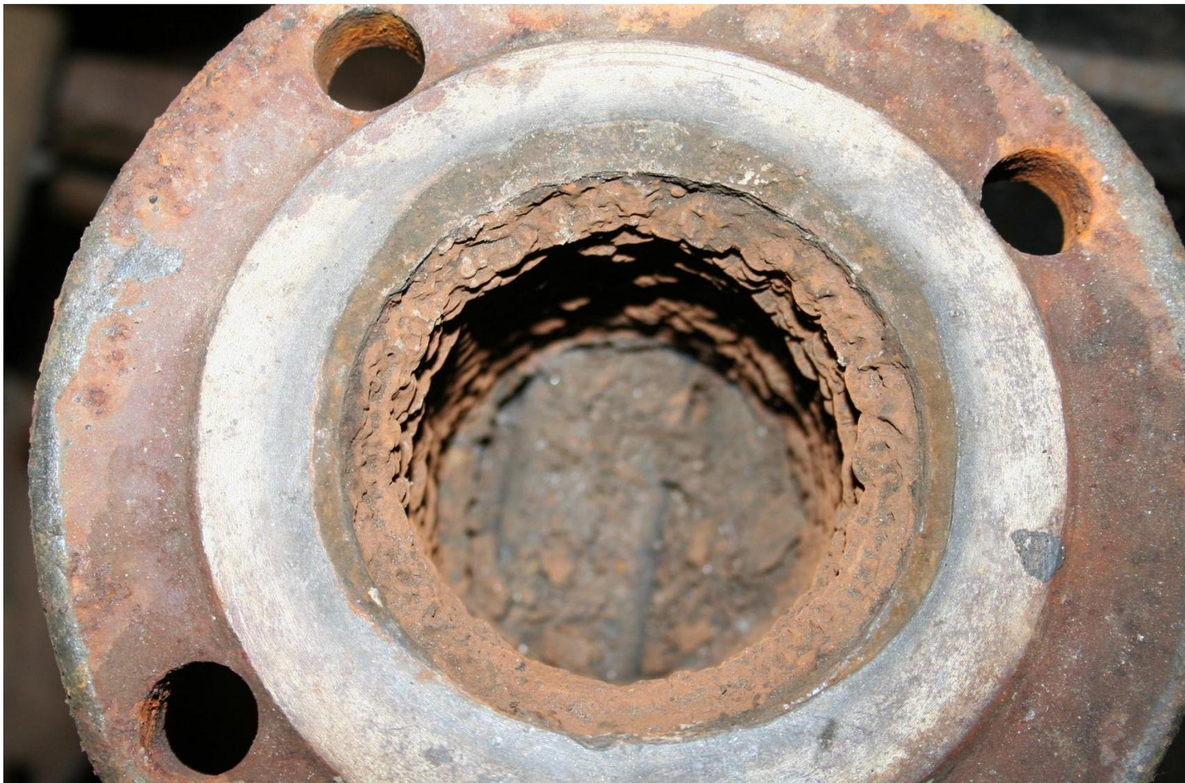
Отложения в трубном коллекторе изготовленном из стали 20. Интенсивно окисляется и разрушается и через 3-5 лет подлежит замене или ремонту.
