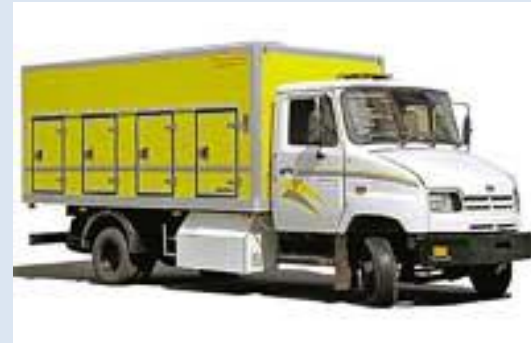
Изотермический автофургон, оборудованный турбохолодильной установкой на ДМЭ
