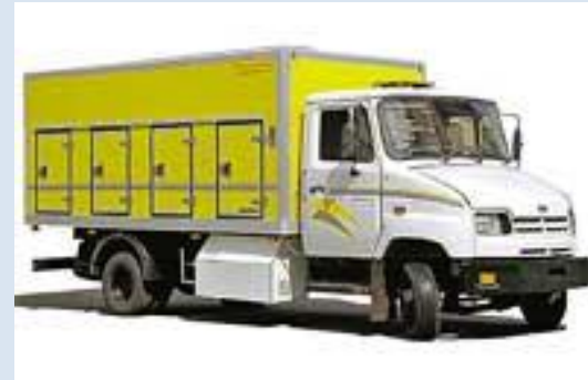
Изотермический автофургон, оборудованный турбохолодильной установкой на ДМЭ
