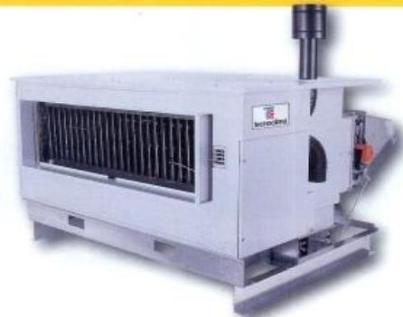
Стандартная конфигурация теплогенераторов **серии UTK-UT** включает специальное перекрытие, для максимальной защиты от атмосферных явлений, комплектацию для дымохода и трубы подачи воздуха горения, фланец для прекращения воздушного канала, приточная камера смешивания воздуха с отверстиями для прокрепления канала воздуха рециркуляции и подачи свежего воздуха.
