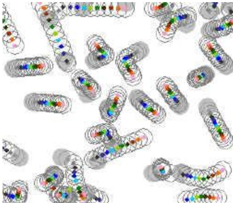
В поиске универсального поведения сыпучих тел Менон с коллегой использовал **высокоскоростную камеру**. Шарики диаметром 1.6 мм. засыпали между двумя вертикальными пластинами из пластика, разнесенных на 1.7
