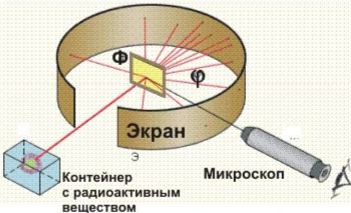
Схема опыта Резерфорда по рассеянию \alpha - частиц.
