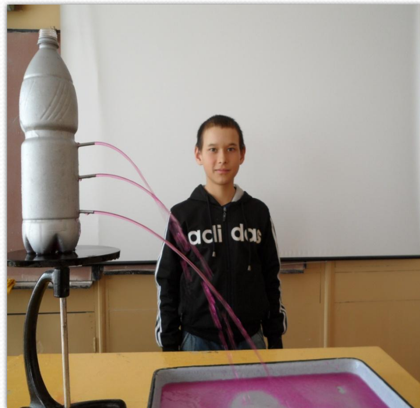
Демонстрация «Зависимость давления от высоты столба жидкости»
