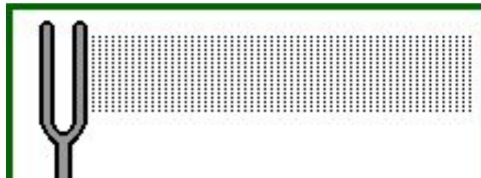
Продольные механические волны могут распространяться в любых средах – твердых, жидких и газообразных
