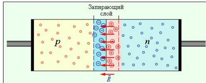
Объемные заряды этого слоя создают между p- и n-областями запирающее напряжение  $U_z$ , приблизительно равное 0,35 В для германиевых p-n-переходов и 0,6 В для кремниевых. n-p-переход обладает удивительным свойством односторонней проводимости.
