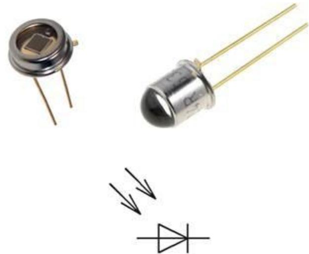
Условное графическое обозначение фотодиода
