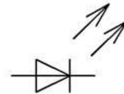
Условное графическое обозначение ИК диода
