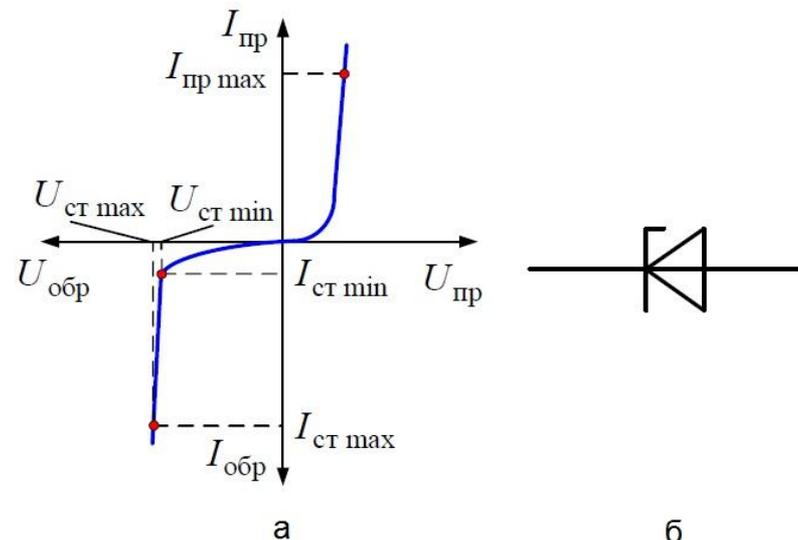
Вольт-амперная характеристика и условное графическое обозначение стабилитрона
