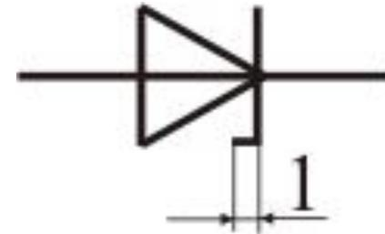
Условное графическое обозначение импульсного диода
