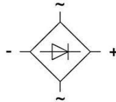
Условное графическое обозначение однофазного моста Гретца
