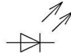
Условное графическое обозначение светодиода
