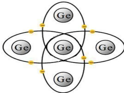
С ростом температуры и освещенности кинетическая энергия валентных электронов повышается, эти связи могут разрушаться, образуя свободный электрон и "дырку". "Дырке" условно приписывается положительный заряд. В электрическом поле они перемещаются между узлами решетки, образуя электрический ток.
