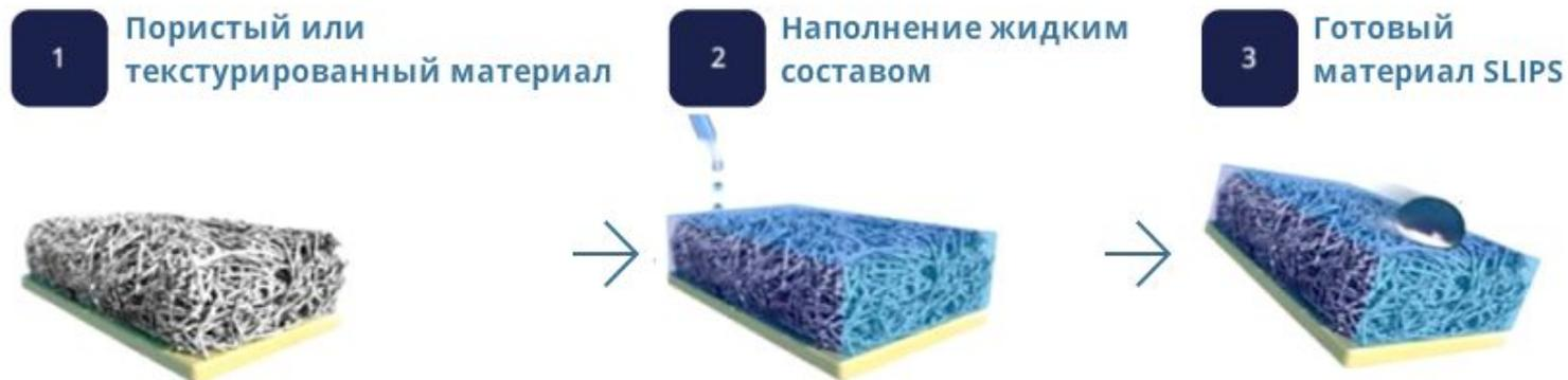
Для подложек используют наноструктурированные материалы на основе металлов, оксидов металлов, углерода, кремния или полимеров. Они могут обладать наноструктурой в объеме (например, нанопорами) или на поверхности (например, нанотекстурой). Такие материалы также могут быть нанесены на многие виды поверхностей, в зависимости от SLIPS применения (металл, стекло, пластик, керамика).
