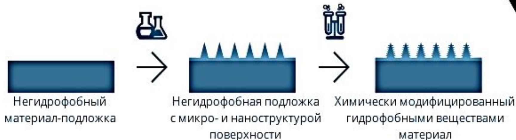
Создать шероховатую подложку и затем химически модифицировать ее при помощи веществ с низкой поверхностной энергией.
