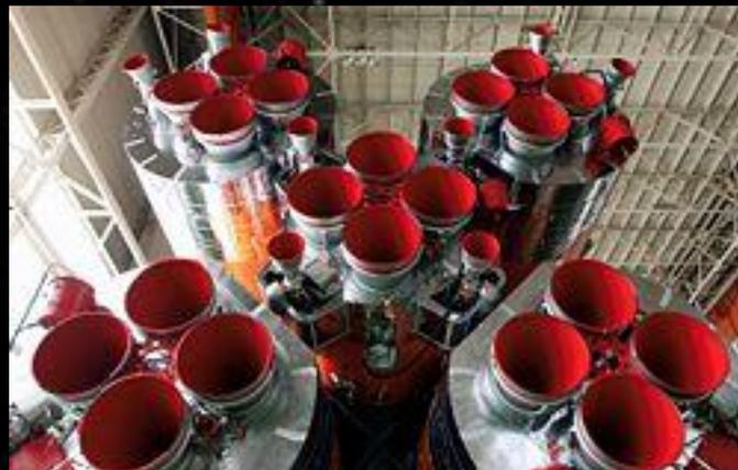
**Двигательная установка РД-107 космического носителя «Союз» в техническом ангаре на космодроме [Байконур](#). Такие двигатели подняли в космос первые [ИСЗ](#) и первых космонавтов. Тяга на Земле — 83.5 тс. Первый полёт — 1957 г.**
