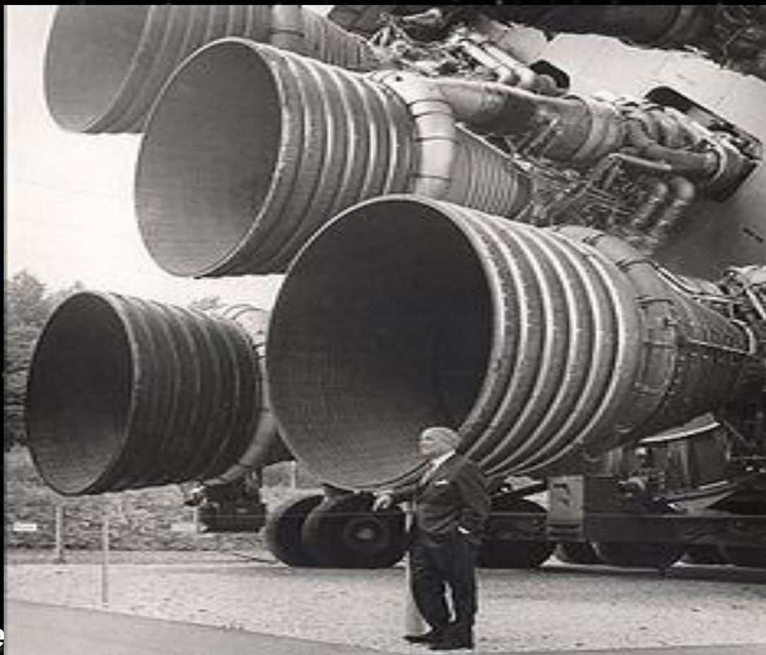
Двигатели Rocketdyne F1, 5 двигателей установлены на 1-ой ступени космического носителя [Сатурн-5](#) Двигательная установка North American Rockwell, Rocketdyne F1, 5 двигателей установлены на 1-ой ступени космического носителя Сатурн-5 рядом с конструктором ракеты [Вернером фон Брауном](#). Эти двигатели обеспечили полёт человека на Луну. Тяга на уровне моря — 691 тс. Первый полёт — 1967 г.
