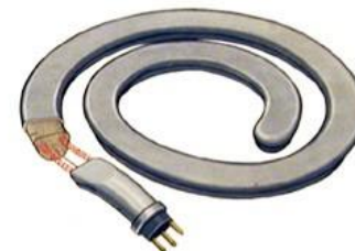
СХЕМА СОЕДИНЕНИЯ СПИРАЛЕЙ В ТРУБЧАТОМ НАГРЕВАТЕЛЬНОМ ЭЛЕМЕНТЕ
