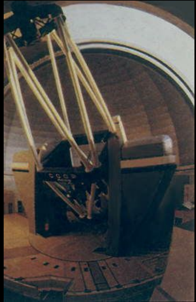
Рефлектор с диаметром главного зеркала 6 м. Специальная астрофизическая обсерватория Российской АН. Северный Кавказ.
