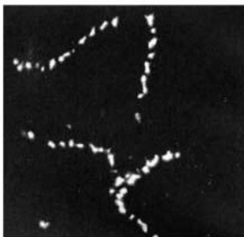
Фотография атомов тория, полученная с помощью электронного микроскопа
