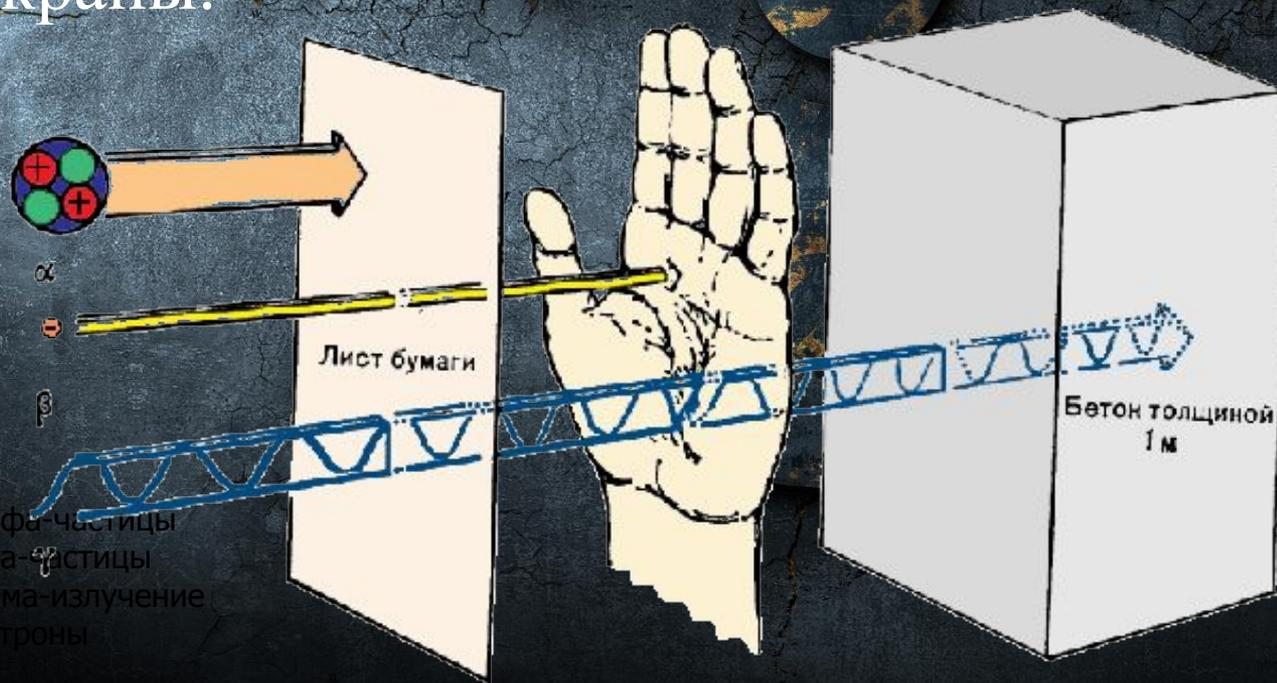
Бетонная стена задерживает α-частицы, β-частицы, γ-излучение и нейтронное излучение
