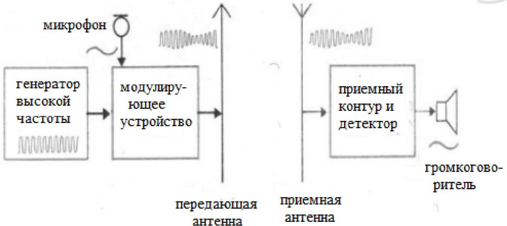
**Амплитудная модуляция**-наложение на высокочастотные колебания колебания низкой частоты.
