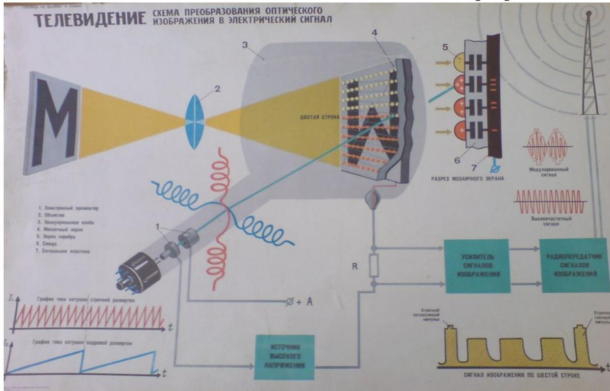
На передающей станции с помощью иконоскопа производится преобразование изображения в последовательность электрических сигналов.
