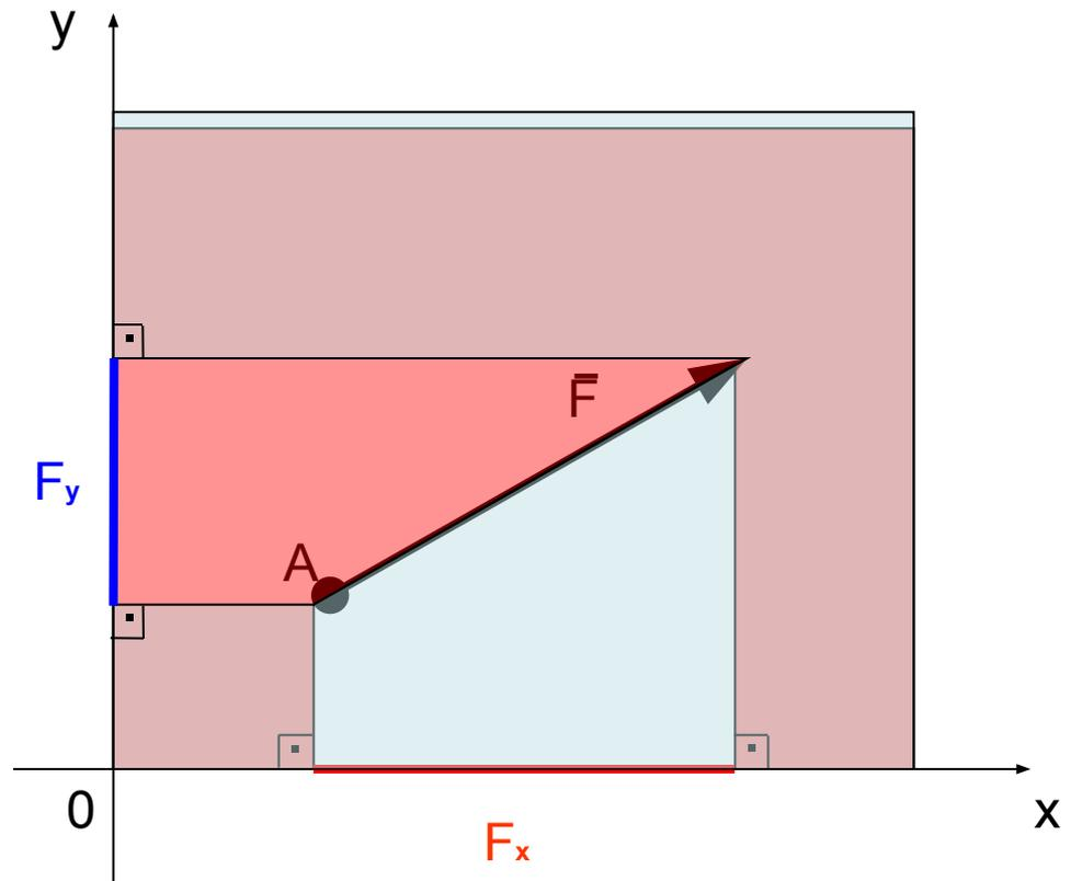
Величина проекции силы на ось равна произведению модуля силы на косинус угла между вектором силы и положительным направлением оси:
