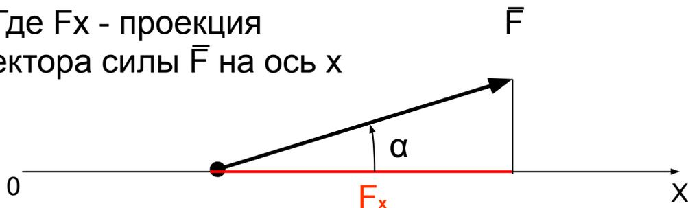
Проекция имеет знак: положительный при одинаковом направлении вектора силы и положительным направлением оси:
