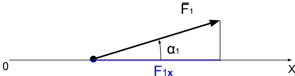
Проекция имеет знак: отрицательный при направлении в сторону отрицательной полуоси:
