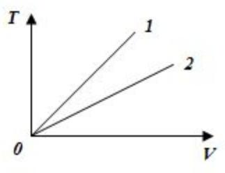
На рисунке изображены графики изобарного расширения (нагревания) двух порций одного и того же идеального газа при одном и том же давлении. Почему изобара 1 лежит выше изобары 2? Ответ обоснуйте. Какие физические закономерности вы использовали для обоснования ответа?
