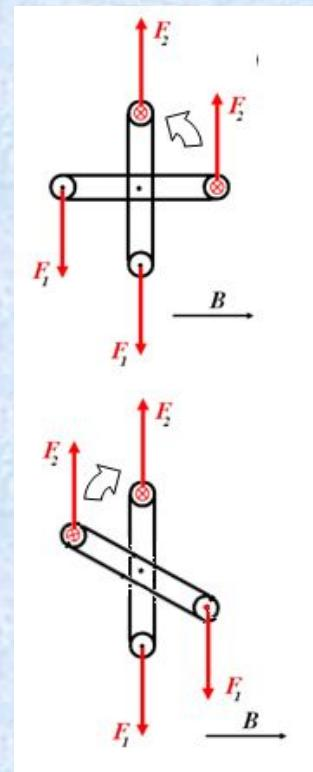
Рамку с постоянным током удерживают неподвижно в поле полосового магнита (см. рисунок). Полярность подключения источника тока к выводам рамки показана на рисунке. Как будет двигаться рамка на неподвижной оси МО, если рамку не удерживать? Ответ поясните, указав, какие физические закономерности вы использовали для объяснения. Считать, что рамка испытывает небольшое сопротивление движению со стороны воздуха.
