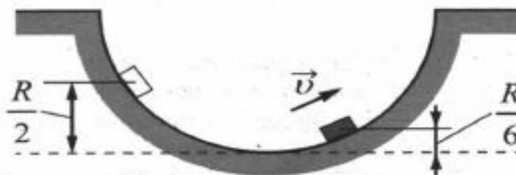
К шайбе приложены сила тяжести  $m\vec{g}$ , направленная вертикально вниз, и сила реакции поверхности  $\vec{N}$ , направленная по радиусу вверх. Ускорение шайбы  $\vec{a}$  направлено внутрь траектории левее направления силы  $\vec{N}$  (см. рисунок).
