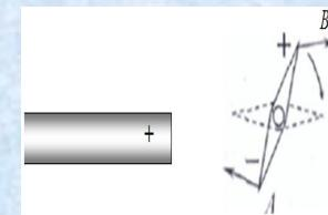
Между двумя близко расположенными металлическими пластинами, укрепленными на изолирующих подставках, положили металлический шарик. Когда пластины подсоединили к клеммам высоковольтного выпрямителя, подав на них заряды разных знаков, шарик пришёл в движение. Опишите и объясните движение шарика
