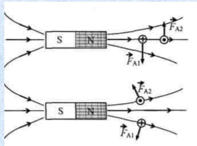
Медная прямоугольная рамка, по которой протекает постоянный электрический ток силой  $I$ , может вращаться вокруг вертикальной оси  $O O'$ , закрепленной в подшипниках. При вращении рамки на нее действуют силы вязкого трения. Опирайсь на законы электродинамики и механики, опишите и объясните движение этой рамки после включения однородного магнитного поля с индукцией  $B$  (см. рисунок).
