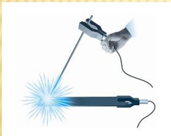
Газовый разряд электросварки
