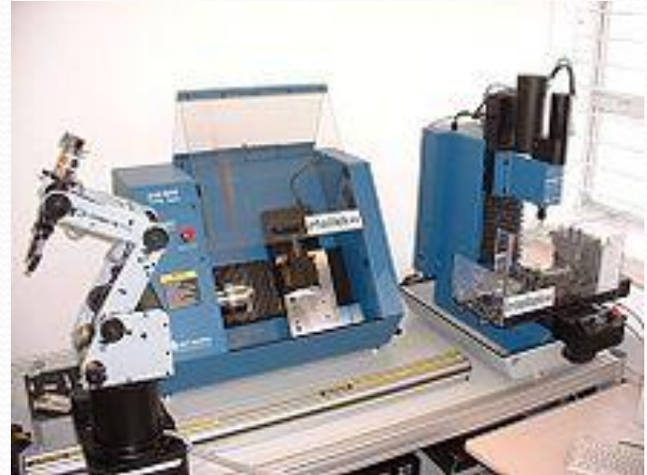
Учебная мехатронная система: учебный робот SCORBOT-ER 4i обслуживает настольные станки с ЧПУ
