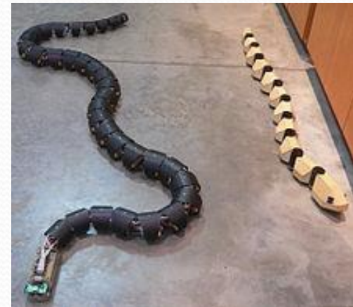
Два змееподобных робота. Левый оснащен 64-мя приводами, правый десятью.
