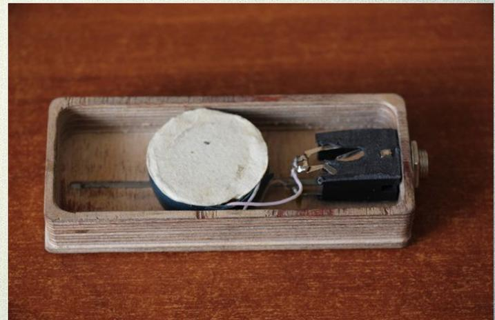
Вокруг постоянного магнита намотано около 3000 витков медной проволоки толщиной 0,02мм. К ее концу припаян гибкий провод для удобства монтажа, который припаян к разъему. Все это приклеено к деревянному корпусу, в котором есть прорезь для стальной пластины, проводящей электромагнитное поле. Таким образом, пластина является продолжением магнита.
