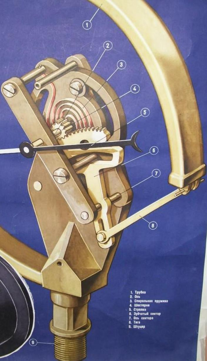
1. Согнутая в дугу металлическая трубка.
