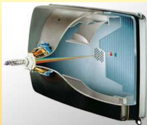
Электронно – лучевая трубка телевизоров
