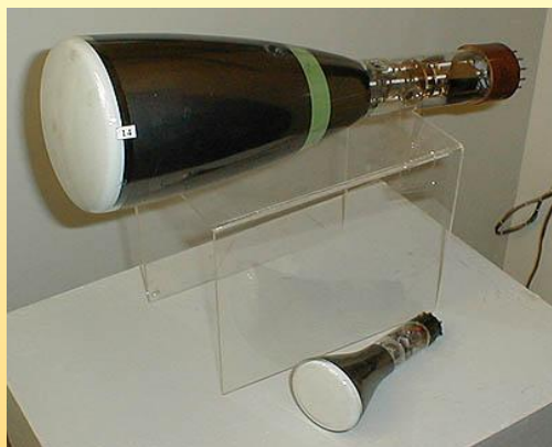
Электронно – лучевая трубка телевизоров
