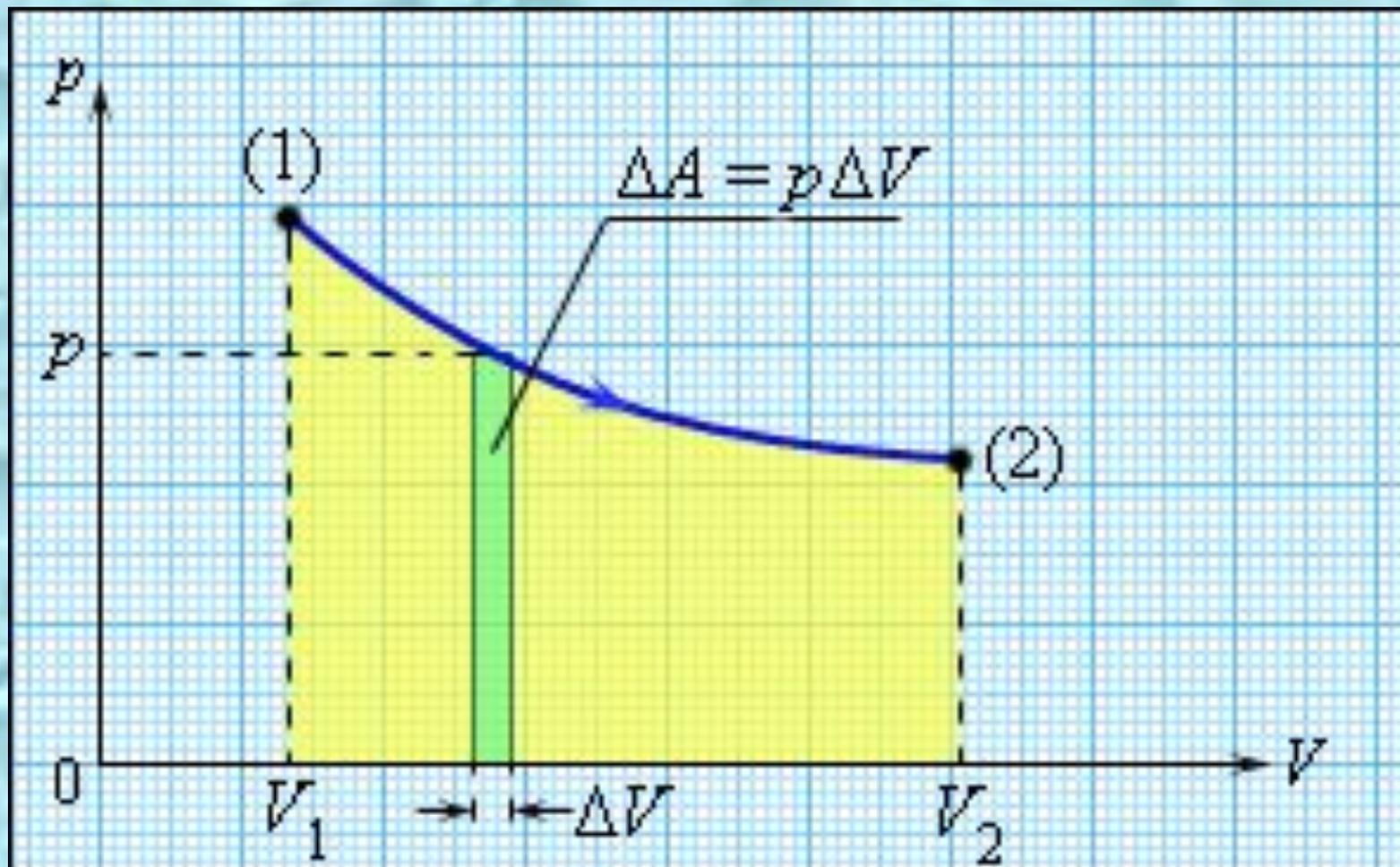
Работа в термодинамике зависит от последовательности состояний, которую проходит тело от начального до конечного состояния
