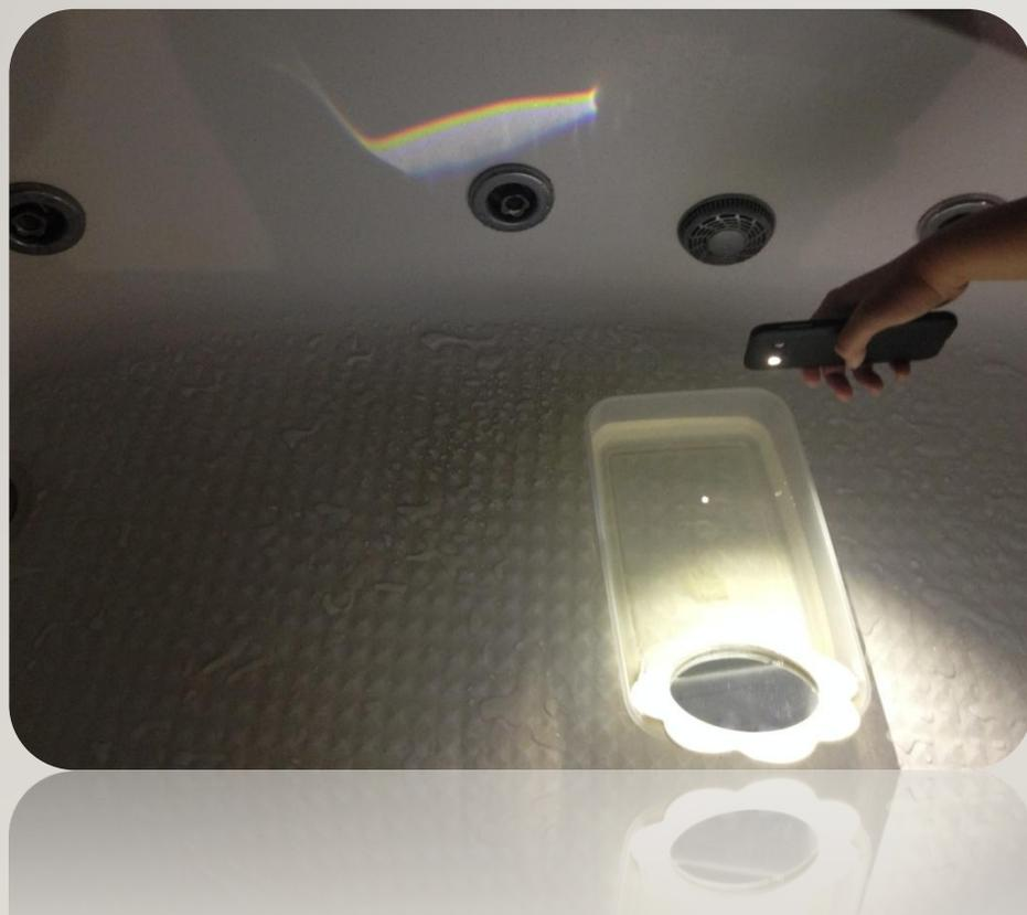
НЕОБХОДИМО ПОЛОЖИТЬ ЗЕРКАЛЬЦЕ В НЕГЛУБОКУЮ ЕМКОСТЬ С ВОДОЙ, КАК ПОКАЗАНО НА ПРИВЕДЕННОЙ РЯДОМ ФОТОГРАФИИ; ЗАТЕМ РАСПОЛОЖИТЬ ЕМКОСТЬ ТАК, ЧТОБЫ ЛУЧ СВЕТА ОТРАЗИЛСЯ ОТ ЗЕРКАЛЬЦА НА КАКУЮ-ЛИБО ПОВЕРХНОСТЬ; ЛУЧШЕ ВСЕГО, ЧТОБЫ ПОВЕРХНОСТЬ БЫЛА БЕЛОГО ЦВЕТА. УГОЛ НАКЛОНА ЗЕРКАЛА ДОЛЖЕН БЫТЬ  $42^\circ$ .
