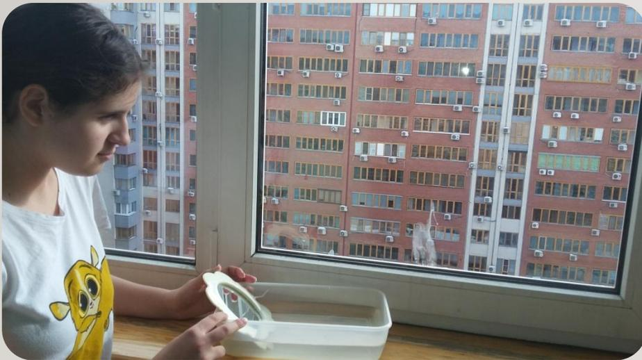
ОПЫТ ДОЛЖЕН ПРОВОДИТЬСЯ В СОЛНЕЧНУЮ ПОГОДУ. НЕОБХОДИМО ПОЛОЖИТЬ ЗЕРКАЛЬЦЕ В НЕГЛУБОКУЮ ЕМКОСТЬ С ВОДОЙ, КАК ПОКАЗАНО НА НИЖЕПРИВЕДЕННОЙ ФОТОГРАФИИ; ЗАТЕМ РАСПОЛОЖИТЬ ЕМКОСТЬ ТАК, ЧТОБЫ ЛУЧ СОЛНЕЧНОГО СВЕТА ОТРАЗИЛСЯ ОТ ЗЕРКАЛЬЦА НА КАКУЮ-ЛИБО ПОВЕРХНОСТЬ; УГОЛ НАКЛОНА ЗЕРКАЛА ДОЛЖЕН БЫТЬ  $42^\circ$ .
