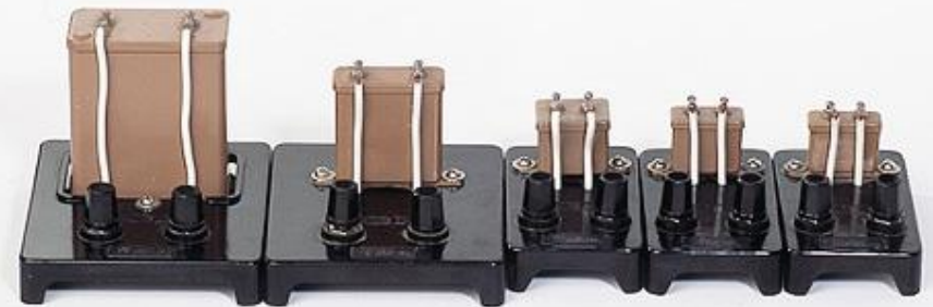
Конденсаторы бумажные разной емкости на одно напряжение
